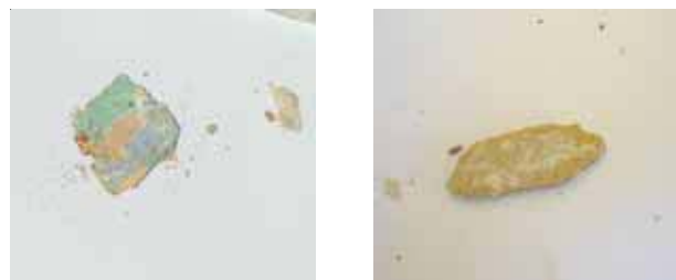
“Calas de color del siglo XVIII, tomadas de los inmuebles Edificio de Ochoa, Benito Juárez No. 193, 211 y 219 del interior en donde se observa el color rosado obtenido del rojo oxido combinado con blanco.”
